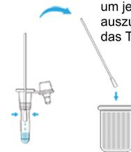
12. Setzen Sie die Tropfspitze fest auf das Extraktionsrohr.
